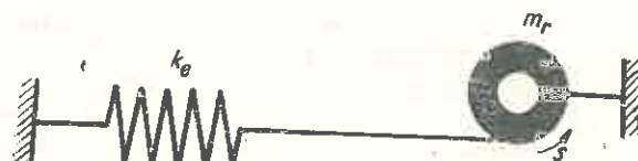
Fig. 2. Schema echivalentă pentru determinarea efortului din cablul trîgător în cazul opririi motorului în sarcină.
