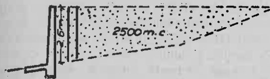
Fig. 2. Sondă în aterisamentul barajului 6, perimetrul Corbeni, valea Obia. Într-o perioadă de un an de viituri mici, barajul a fost umplut cu material fin (argile)
