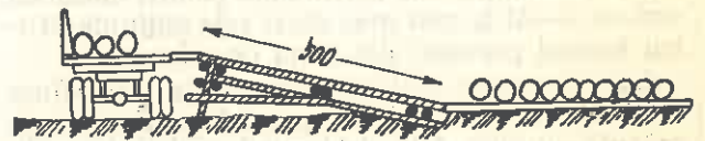
Fig. 2. Rampa mobilă simplă pe capre „în rampă”.
