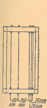
Fig. 2. Model de așezare a pinzelor în gater
