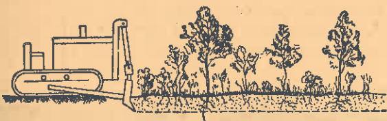
Fig. 5. — Modul de lucru în cazul defrișării arboretului cu ajutorul defrișatorului D.—210 V.
