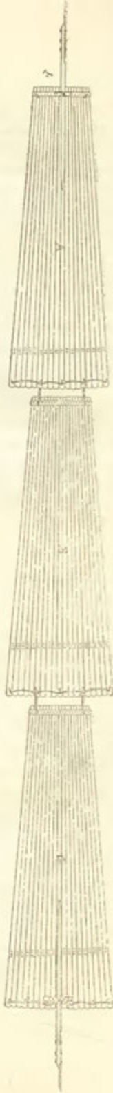
Fig. 12. — Modul de așezare a cîrmei la capătul de dinapoi și sistemul de legat a lemnurilor.
