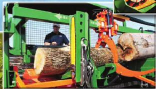
Linii automate de tăiere / despicare lemn de foc (35 mc / h)
