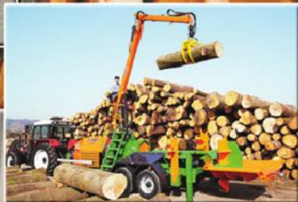
Despicătoare industriale orizontale (18 mc / h)
