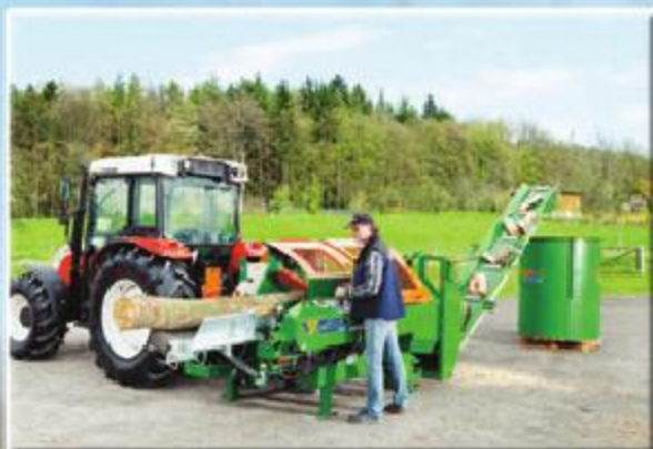
Linii automate de tăiere / despicare lemn de foc (3 mc / h)
