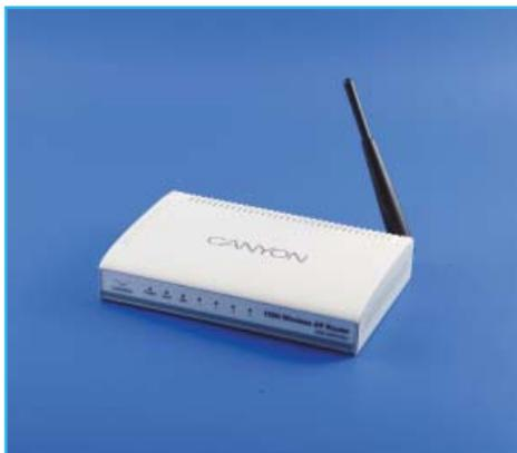
Protocoale: Ethernet, 802.11b/g/n · Facilități: Port forwarding, DNS dinamic, Management de bandă · Conectori: 1WAN, 4LAN
