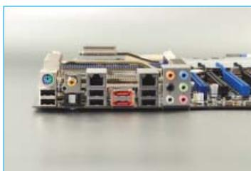
ASUS P6T7 WS SuperComputer este o placă de bază pentru platforma LGA 1366, destinată configurațiilor de tip workstation.
