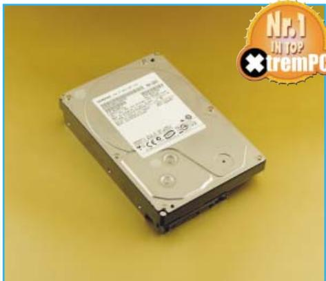
Serie: Deskstar 7K1000.B · Capacitate: 1TB · Interfață: SATA II · Viteză de rotație platane: 7200RPM · Buffer: 16MB · Număr platane: 3
