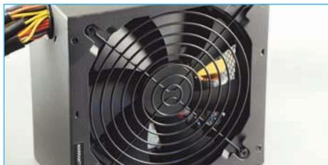
Corsair TX850W este o sursă de alimentare conformă cu specificațiile "80 PLUS", capabilă să ofere o putere maximă de 850W.
