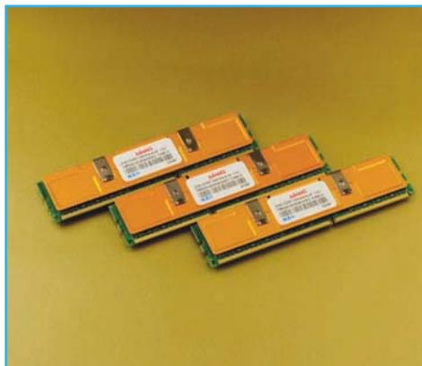
Capacitate: 3x2GB · Frecvență: 1333MHz · Latențe: 8-8-8-24-2T · Tensiune de alimentare: 1.5V
