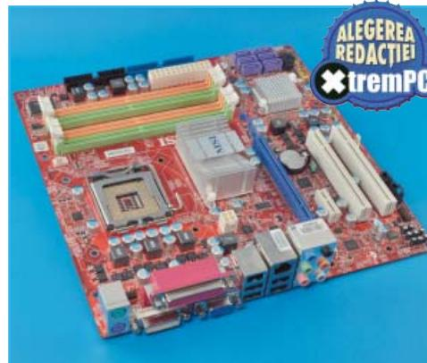
Chipset: Intel G45+ICH10R • Interfață grafică: GMA 4500 • Proces de fabricație: 65nm • Conectori video: DVI, VGA
