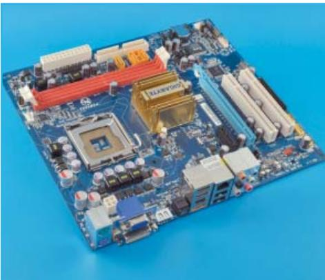
Chipset: NVIDIA nForce 630i · Interfață grafică: GeForce 7150 · Proces de fabricație: 90nm · Conectori video: DVI, VGA, HDMI
