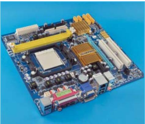
Chipset: AMD 740G+SB700 · Interfață grafică: Radeon 2100 · Proces de fabricație: 55nm · Conectori video: DVI, VGA, HDMI
