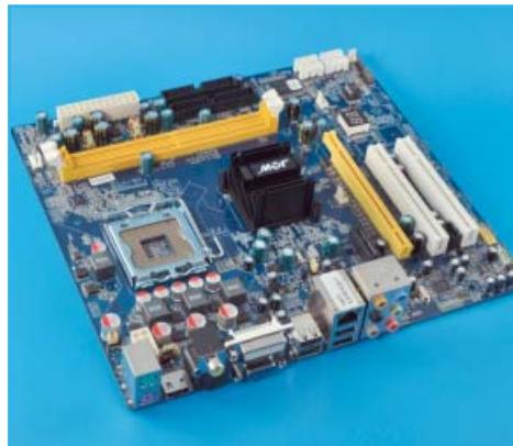
Chipset: NVIDIA nForce 630i · Interfață grafică: GeForce 7100 · Proces de fabricație: 90nm · Conectori video: DVI, VGA, HDMI
