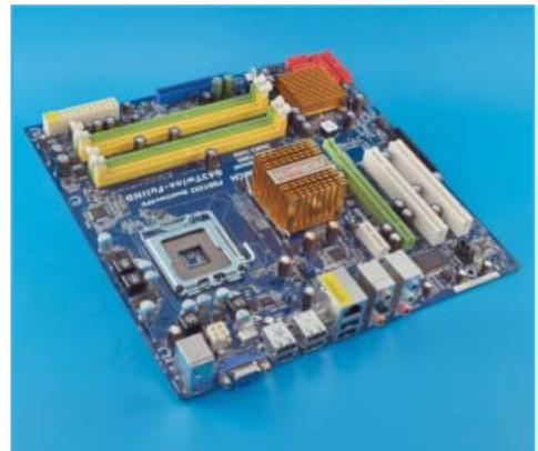
Chipset: Intel G43+ICH10R · Interfață grafică: GMA4300 · Proces de fabricație: 65nm · Conectori video: DVI, VGA, DisplayPort
