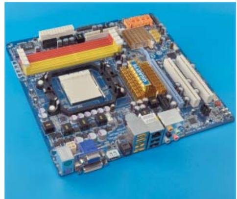
Chipset: AMD 780G+SB700 · Interfață grafică: Radeon HD 3200 · Proces de fabricație: 55nm · Conectori video: DVI, VGA, HDMI
