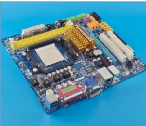
Chipset: NVIDIA GeForce 8200 · Interfață grafică: GeForce 8200 · Proces de fabricație: 65nm · Conectori video: DVI, VGA, HDMI
