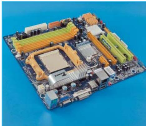
Chipset: AMD 780G+SB700 · Interfață grafică: Radeon HD 3200 · Proces de fabricație: 55nm · Conectori video: DVI, VGA
