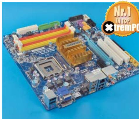
Chipset: NVIDIA GeForce 9400 • Interfață grafică: GeForce 9400 • Proces de fabricație: 65nm • Conectori video: DVI, VGA, HDMI
