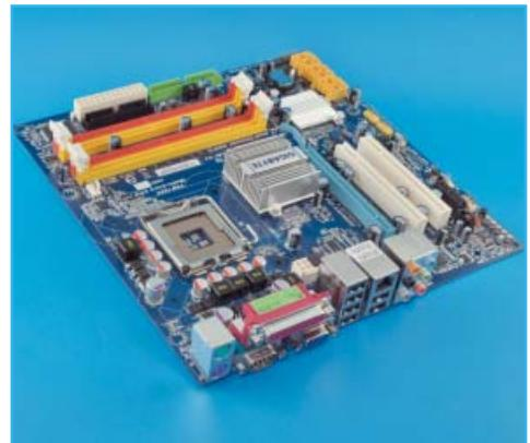
Chipset: Intel Q35+ICH9DH · Interfață grafică: GMA 3100 · Proces de fabricație: 90nm · Conectori video: VGA
