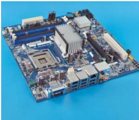
Chipset: Intel G45+ICH10R · Interfață grafică: GMA 4500 · Proces de fabricație: 65nm · Conectori video: DVI, HDMI
