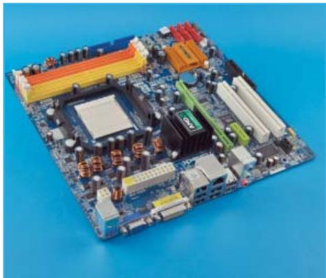
Chipset: AMD 780G+SB700 · Interfață grafică: Radeon HD 3200 · Proces de fabricație: 55nm · Conectori video: DVI, VGA, HDMI, DisplayPort
