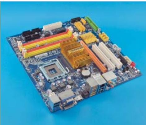
Chipset: Intel G45+ICH10R · Interfață grafică: GMA 4500 · Proces de fabricație: 65nm · Conectori video: DVI, VGA, HDMI
