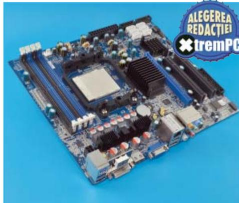
Chipset: AMD 780G+SB700 · Interfață grafică: Radeon HD 3200 · Proces de fabricație: 55nm · Conectori video: DVI, VGA, HDMI
