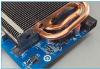
GIGABYTE oferă prin GV-NX96T512HP o placă grafică GeForce 9600GT cu sistem de răcire pasiv.
