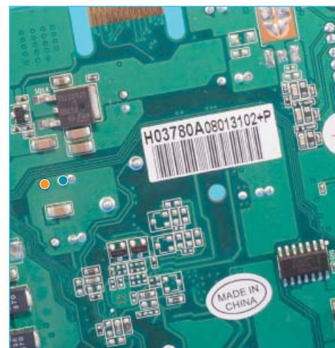
● Punct de măsurare a tensiunii nucleului grafic ● GND (masă)
