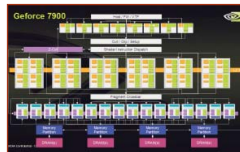
➤ Diagrama-bloc a nucleului GeForce 7900GTX, asemănătoare cu cea a seriei precedente
