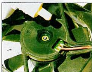
Ungerea axului ventilatorului cu ulei pentru mecanisme fine
