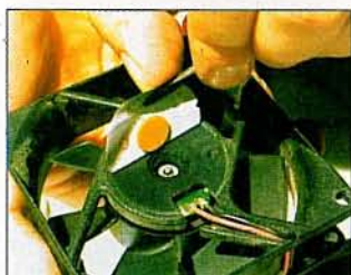
Dezlipirea foliei de protecție pentru a avea acces la axul ventilatorului
