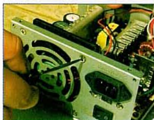
Desfacerea ventilatorului sursei
