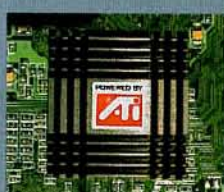
Radiatorul îndeplinește funcția minimă de răcire
