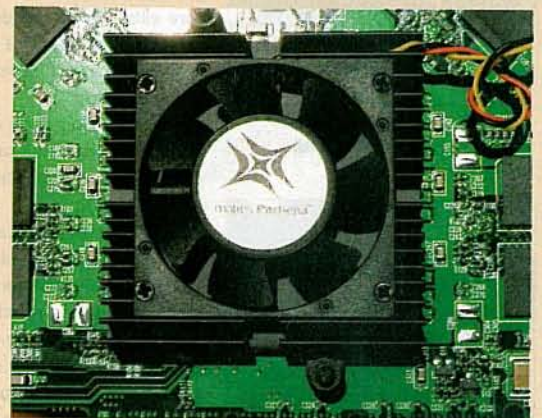
Cooler-ul nu este prea mare, deoarece chip-ul grafic nu se încălzește foarte mult
