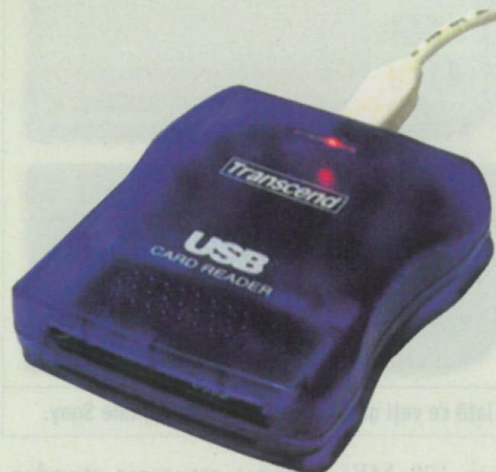
Un banal cititor de carduri Compact Flash.
