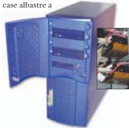
CARO C-ONE FIECARE HARD DISK ESTE RĂCIT DE PROPRIUL COOLER.
