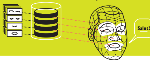
3 Cuvintele și propozițiile sunt create prin alăturarea vizimelor. Se adaugă expresiile faciale, iar piesele se asamblează pe un cadru reprezentând fizionomia actorului.
