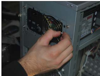
Instalarea sursei de tensiune
