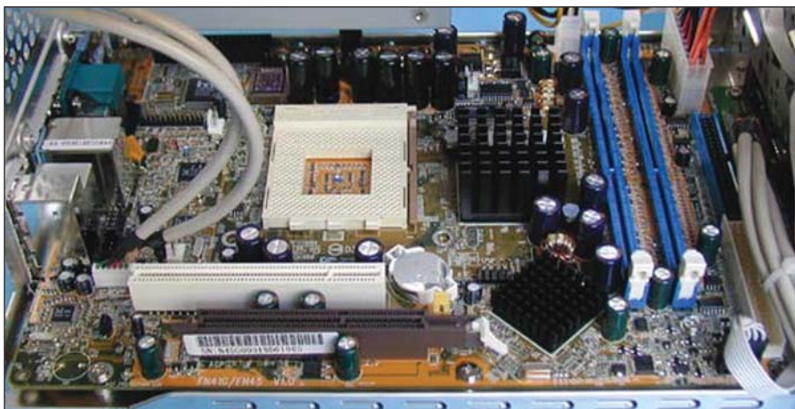
În această imagine poți observa cât de compactă este placa de bază: un singur slot PCI, AGP, North și Southbridge, plus slot-urile DIMM și conectori IDE - totul se află pe o suprafață de 600 de centimetri pătrați
