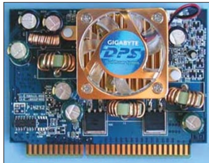
Regulator de tensiune dual - asigură stabilitatea sistemului în condiții adverse de stabilitate
