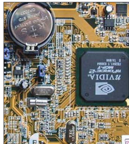
Asus A7N8X 2.0 Deluxe: Asus a considerat serial ATA o caracteristică importantă; de aceea a incorporat pe A7N8X cipul SATA SiI3112
