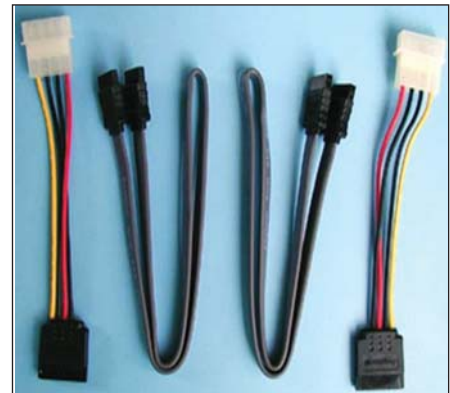
Pe lângă cablurile de date serial ATA, în pachet se mai găsesc și două cabluri de alimentare pentru dicurile SATA. Fără acestea nu ar putea să funcționeze discul; un lucru care se pierde din vedere de către mulți!
