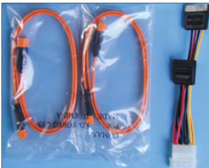
Pentru cele două controlere serial ATA, în pachetul plăcii se găsesc și cabluri de date cât și de tensiune corespunzătoare pentru acestea
