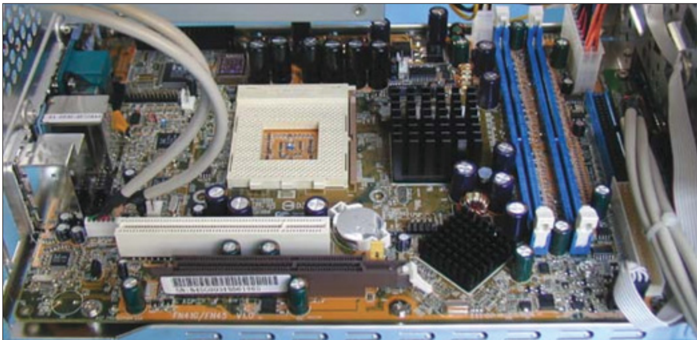
În această imagine poți observa cât de compactă este placa de bază: un singur slot PCI, AGP, North și Southbridge, plus slot-urile DIMM și conectori IDE - totul se află pe o suprafața de 600 de centimetri pătrați
