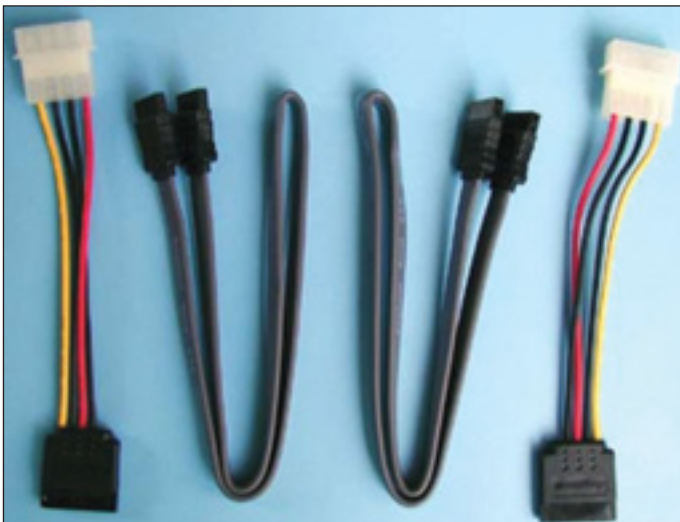
Pe lângă cablurile de date serial ATA, în pachet se mai găsesc și două cabluri de alimentare pentru dicurile SATA. Fără acestea nu ar putea să funcționeze discul; un lucru care se pierde din vedere de către mulți!
