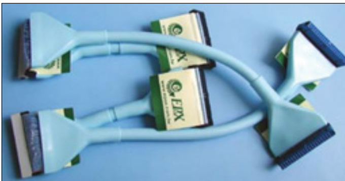
Probabil cea mai bună inovație după apariția lui Ultra ATA: cablurile rotunde!
