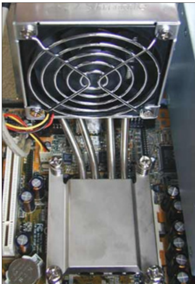
...iar după instalarea radiatorului se instalează ventilatorul. Instalarea celorlalte componente este binecunoscută, însă trebuie să ai în vedere că spațiul este destul de restrâns!
