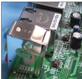
Chipsetul plăcii integrează deja două controlere pentru rețea, însă în cazul lui BRDA3+ s-a folosit un controler de la Realtek care este folosit ca și controler primar (integratul din dreapta).
