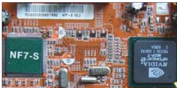
Eticheta verde acoperă inscripționările de pe controlerul Serial ATA 3112 de la Silicon Image. De asemenea, pe ea s-a inscripționat tipul plăcii (NF7-S)
