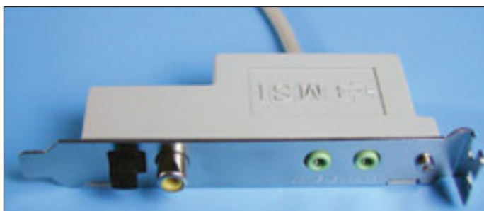
Modulul audio de la MSI are conexiuni pentru sunetul surround, cât și o ieșire digitală, și una RCA
