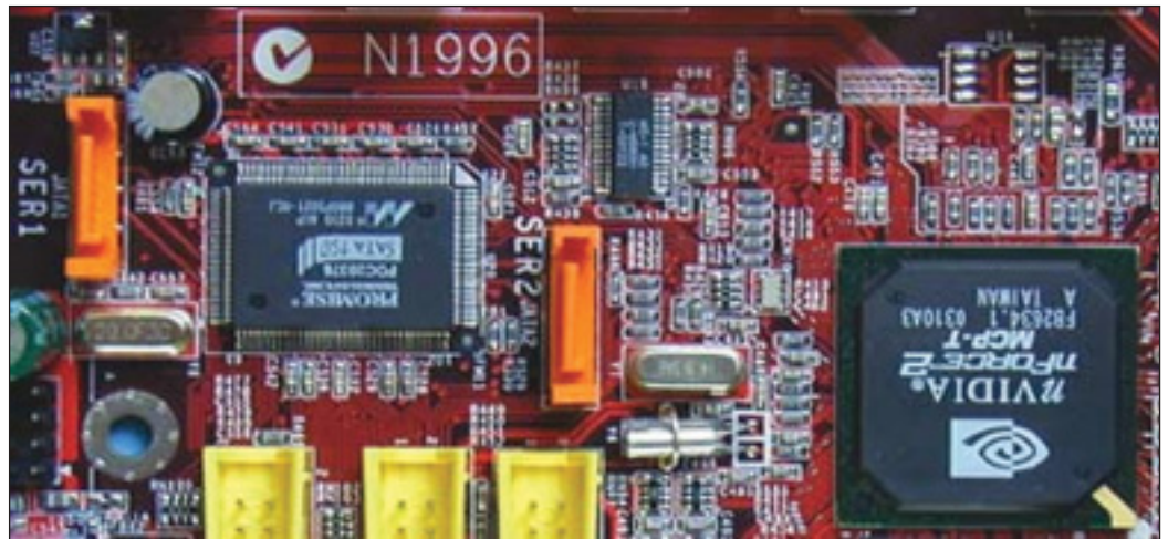
Placa include și două porturi serial ATA. În fine, din cauză că s-a folosit controlerul Promise (PDC20376) pe placă se află încă un canal UltraATA/133, însă acesta este numai pentru hard discuri!
