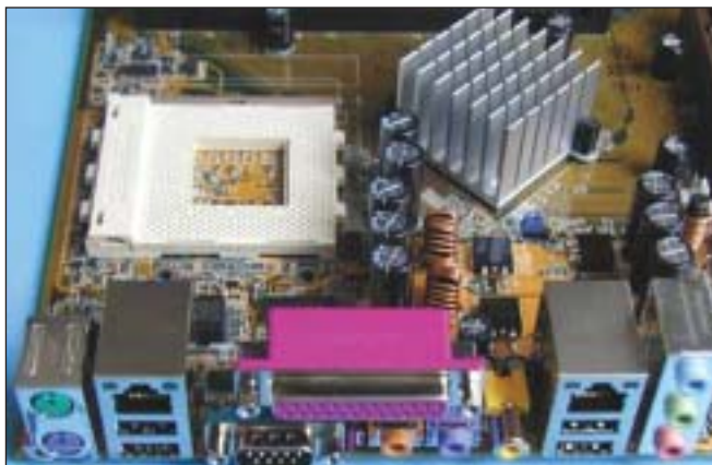
Asus a integrat porturi pe panoul din spate până la refuz. Astfel, găsești aici patru porturi USB, două plăci de rețea de 100Mbiți și o placă de sunet complexă
