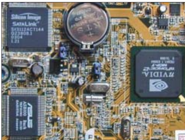
Asus a considerat serial ATA o caracteristică importantă; de aceea a încorporat pe A7N8X cipul SATA Sil3112
