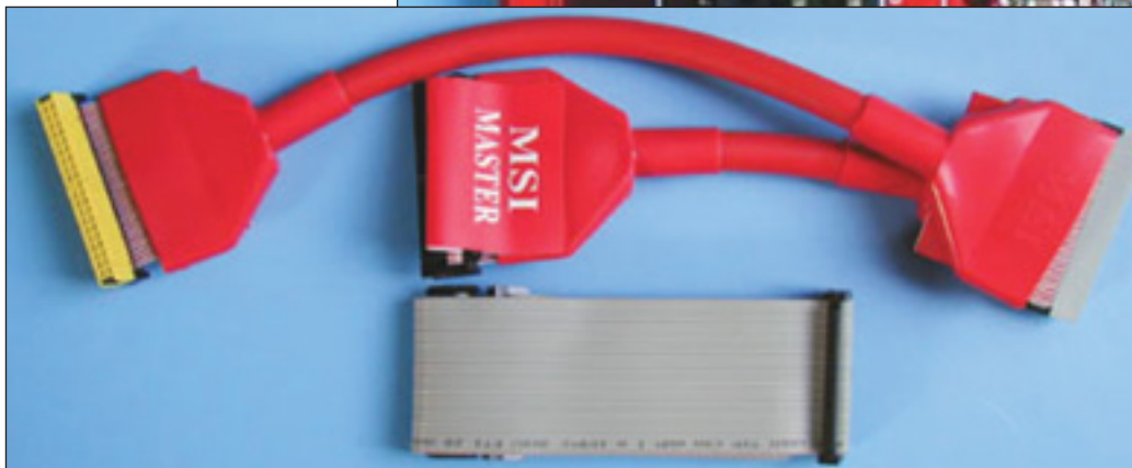
Ca și la alte plăci, MSI a inclus în pachet un cablu rotund care vă face munca mult mai ușoară și reduce potențialul de probleme care pot apărea din cauza cablurilor
