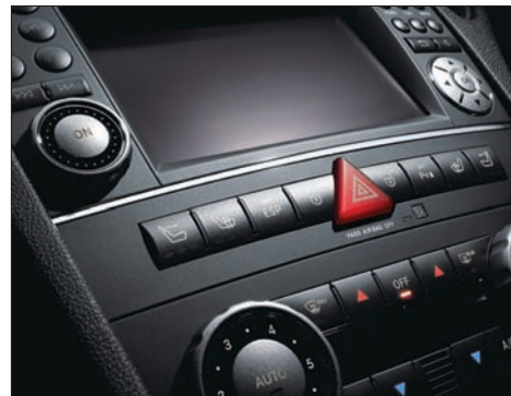
Bluetooth din fabricație: sistemul Comand integrat în Mercedes SLK are inclus în mod standard handsfree bluetooth, relativ puțin complicat.
