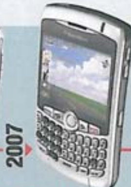
2007 Curve 8300 Curve oferă în partea posterioară o cameră de 2 megapixeli. UMTS lipsește în continuare.
