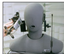
Hear test dummy: la capul sintetic sunt măsurate proprietățile electroacustice.
