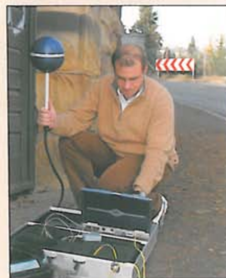
FSL transferă valorile măsurate spre notebook, unde un software special le interpretează.
