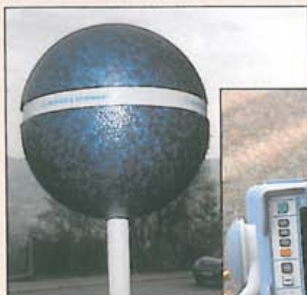
Antena sferică preia semnalele și polarizațiile din toate direcțiile cu câte trei măsurători.
