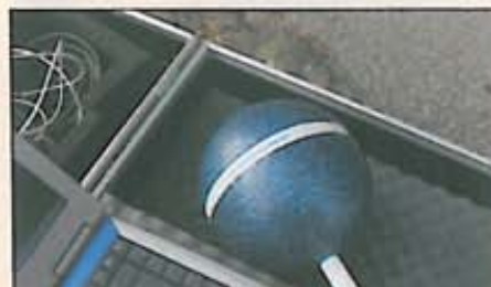
Notebookul controlează analizorul spectral, iar acesta - antena. Sistemul este portabil datorită unei baterii.
