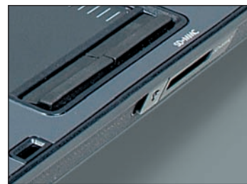
Raritate: un port IrDA pentru transferul datelor este o caracteristică standard la puține notebook-uri.
