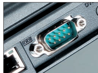
Un oaspete rar: interfața serială a lui Acer este apreciată în mod deosebit de tehnicienii în ale măsurătorilor.
