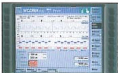
Instalația de măsurări proprii: CMU200 poate măsura și proprietățile mobilelor UMTS.
