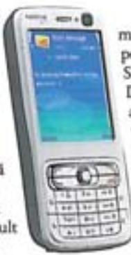
mașină, N73 oferă profilul pentru căști, handsfree și SIM-Access-Bluetooth. Din dotare nu lipesc apelarea și controlul vocal, re-apelarea automată, sau preluarea apelului cu tasta dorită. Dezavantajele modelului în ciuda display-ului mare, textul este prea mic, cifrele au o înălțime de 4 mm și tastele sunt prea înguste.
