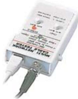
Detector de erori: cu un aparat de testare pentru cablul rețelelor (preț de la 30 de euro) verifică contactul conductoarelor cablului.
