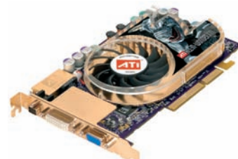
Card combinat: plăcile grafice cu tuner TV integrat sunt și ele o alternativă.
