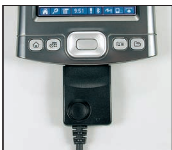
Cablul: conexiunea la calculator se face prin cablu USB.
