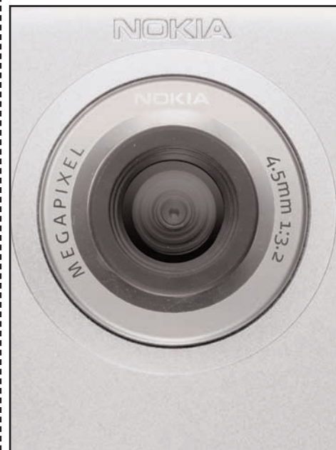
Iluzie optică: obiectivul foto al modelului 6630 e de efect, dar deschiderea obiectivului e mult mai mică.
