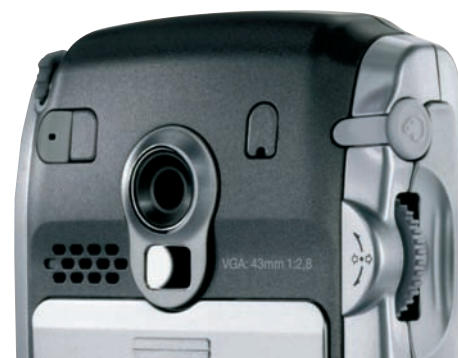
Mini-oglină, lentilă, difuzor și mufă antenă: pe spatele P910i, înghesuială mare.
