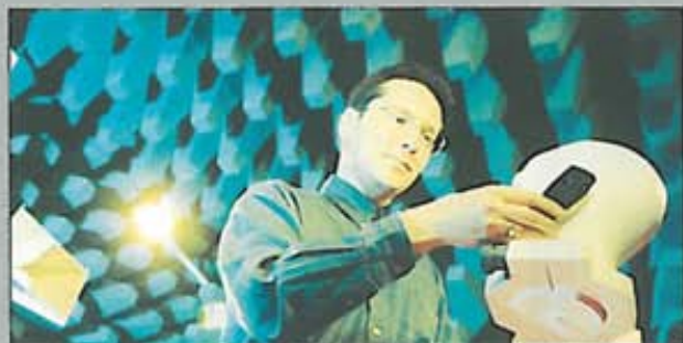
Proprietățile de emisie și recepție în vizor: măsurătorile se fac la capul artificial.
