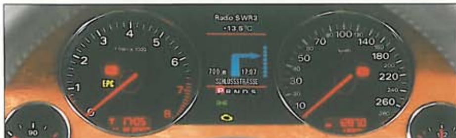
Evantai de elemente: display-ul secundar color efectuează dirijarea prin săgeți, iar la cerere poate afișa agenda telefonică, postul radio sau funcțiile de bord.
