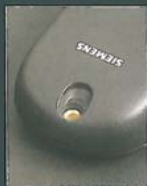
Bun pentru mașină: S35i oferă o interfață pentru conectarea unei antene externe.
