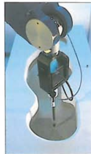
În detaliu: cu ajutorul sondei se determină puterea câmpului electric din interiorul corpului.
