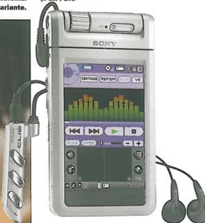
54 Tehnica lui Sony Clié PEG-NR70V reunește o cameră video, un player MP3 și un PDA.
