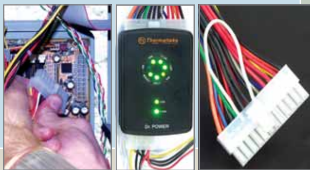
Deconectare: scoatem conectorul ATX de pe placa de bază. Apoi pornim sursa: putem alege una dintre cele două variante, fie să folosim Thermaltake Dr. Power, fie să realizăm un scurtcircuit între firul verde și unul din firele negre ale conectorului ATX.
