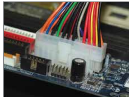
Conector ATX: sursele mai noi au o alimentare suplimentară și de aceea conectorul pentru placa de bază este mai mare. Cu toate acestea, el funcționează fără probleme și pe o placă de bază mai veche, bineînțeles cu condiția să nu fie incompatibil de componentele plăcii (condensatori etc.).
