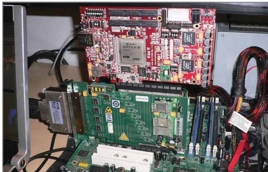
Prototip: FresoLogic a realizat un prototip de controller USB 3.0 capabil să funcționeze la 300-350 MB/s.
