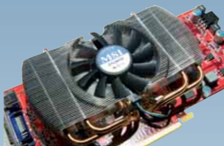
MSI N9800 GT Zilent: VF1050 este numele coolerului Zalman folosit de către MSI pentru răcirea lui 9800GT.
