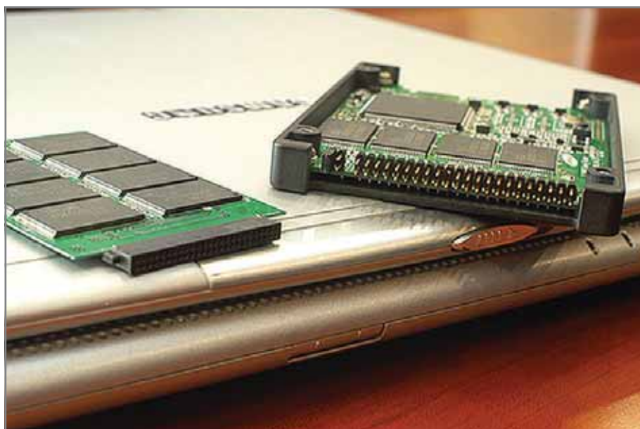
Electronică: SSD-urile nu au componente în mișcare și de aceea sunt practic imune la șocuri și vibrații.
