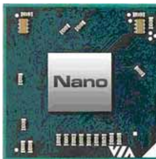
Via Nano: procesoare ultra-subțiri, care funcționează la tensiune mică, destinate notebook-urilor ultraportabile și computerelor ultramobile.
