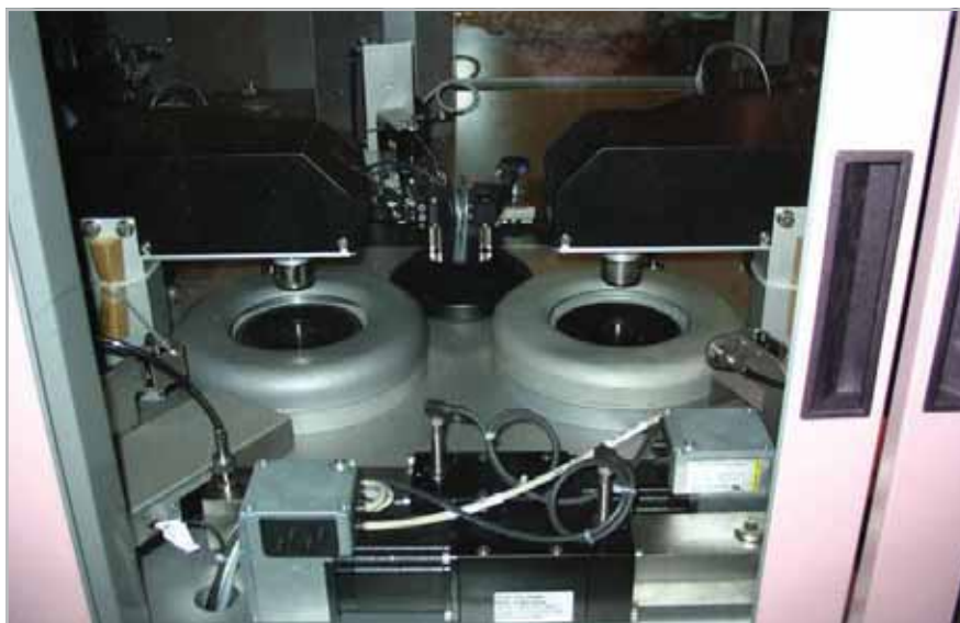
Tehnologia VMD: linia de fabricație pentru un disc cu patru straturi folosește mașinile clasice utilizate la producerea DVD-urilor.
