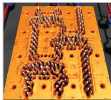
Cascadă: IBM propune circuite foarte mici folosind cascade de molecule.
