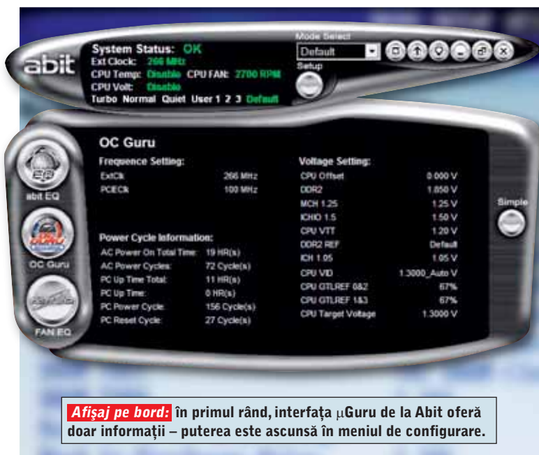
Aplicație profesională: meniul de configurare al μGuru este convingător datorită multiplelor opțiuni de tuning care sunt salvate în trei profiluri de utilizator.
