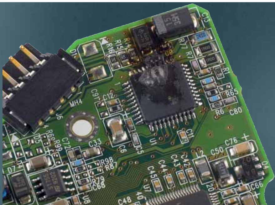
Recunoașterea PCB-urilor defecte: cipurile defecte pot fi recunoscute chiar și fără lupă.
