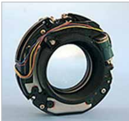
Mecanică fină: unitatea de stabilizare a obiectivului Nikon arată cât de complexă este această metodă de stabilizare optică.
