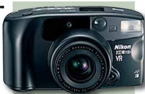
Nikon Zoom 700VR: aparatul compact cu data de naștere în anul 1994 a fost primul model din lume cu stabilizator de imagine integrat. A fost piatra de temelie pentru sistemul VR (Vibration Reduction) de la Nikon, care se bazează pe o stabilizare cu lentile amovibile.
