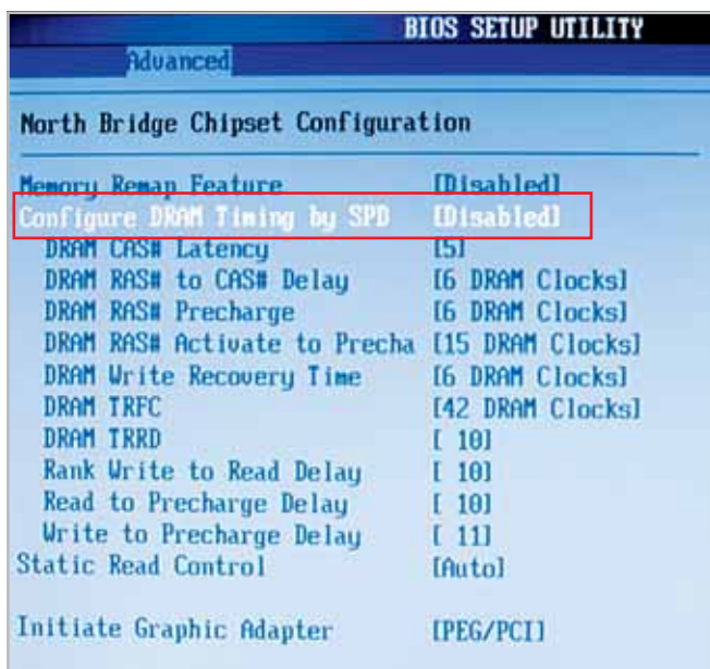
Configure DRAM Timing: modulele rapide de memorie pot profita de pe urma timing-urilor optimizate.
