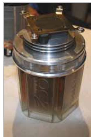
Eficiență: cooler de la OCZ cu lichid de răcire și nanotuburi de carbon.
