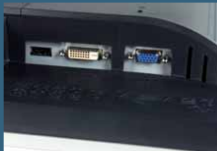
Dotări unice: BenQ FP222WH este singurul reprezentant din test ce se mândrește cu un conector HDMI, alături de clasicele DVI și D-sub.
