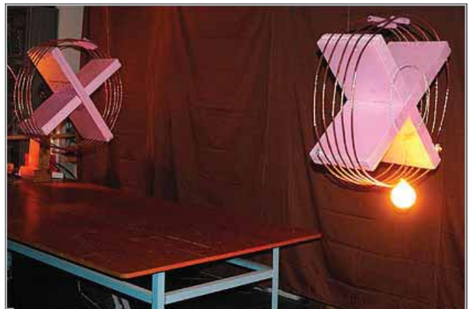
Din nou fără cablu: energia este transferată cu ajutorul a două antene ce rezonază pe frecvența de 10 MHz.
