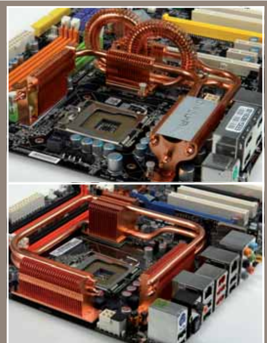
Sisteme de răcire ce „dau bine”: îmbină utilul și frumosul, cu accent pe al doilea element (marketing-ul e de vină). Sus: Circu-Pipe-ul de la MSI, jos un heat-pipe-urile plăcii ASUS.
