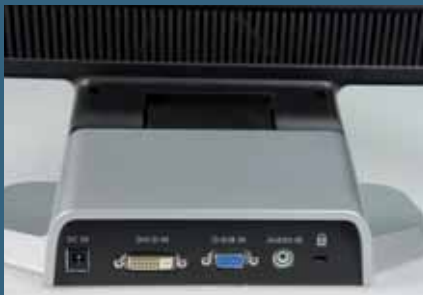
Ergonomie conectori: ACER AL2251W permite instalarea facilă a cablurilor video/ audio, dar și a cablului de alimentare.
