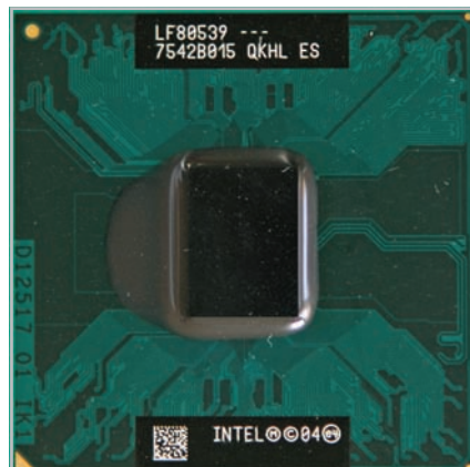
Procesorul mobil de ultimă generație: chiar dacă este socket 478, așezarea pinilor îl face incompatibil cu procesoarele mai vechi Dothan sau Banias.
