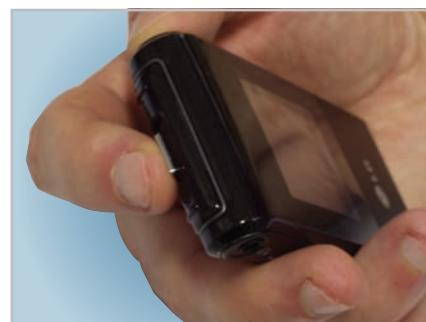
Soluția de control propusă de LG: un Joystick unidimensional amplasat pe o latură a playerului.
