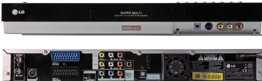
LG RH188: conectica din spatele aparatului este similară cu a modelului Hitachi (mai puțin conectorul HDMI). Poziționarea inspirată a butoanelor de control aduce un spor de ergonomie.
