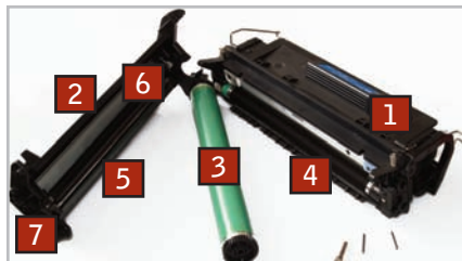
Desfăcând o unitate de imagine completă, putem vedea părțile componente: 1- Unitate dezvoltare; 2-Unitate ștergere; 3-Cilindru fotosensibil; 4-Rolă magnetică; 5-Lamelă ștergere; 6-Rolă încărcare; 7-Recipient toner rezidual
