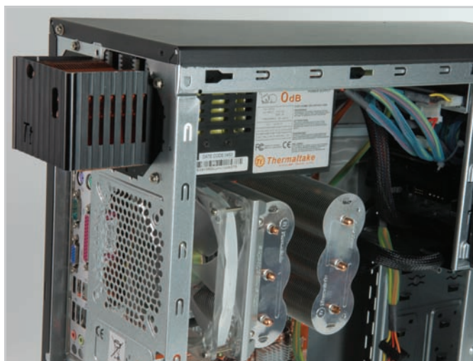
Thermaltake Fanless PurePower 350: Are heatpipe-uri și transferă căldura la lamelele aflate în afara carcasei sursei, atât în exteriorul sistemului, cât și (din nefericire) în interiorul său.
