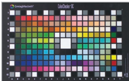
GretagMacbeth ColorChecker DC: Așa arată etalonul folosit pentru evaluarea deviației de culoare.
