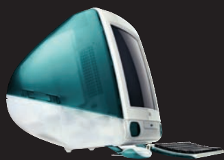
iMac G3: 15 august 1998 Procesor: PowerPC 750 233 MHz, Video: ATI Rage Ilc, RAM: 32 MB, HDD: 4 GB, CD-ROM, ethernet, boxe stereo, monitor 15"
