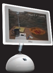
iMac G4: 7 ianuarie 2002 Procesor: PowerPC 7441 700/800 MHz, Video: nVidia GeForce2 MX, RAM: 128/ 256 MB, HDD: 40/60 GB, CD-RW, modem, ethernet
