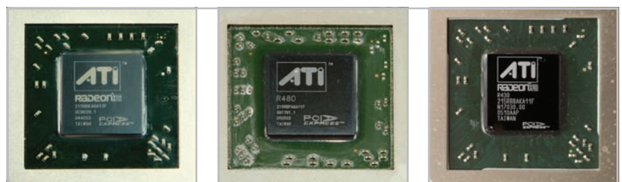
Cele trei cipuri care echipează plăcile din seria X800GTO. În timp ce R423 și R480 sunt construite pe tehnologia de 130 nm, R430 coboară la 110 nm.
