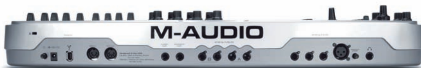
Conexiunile aflate la spatele unui Ozonic.
