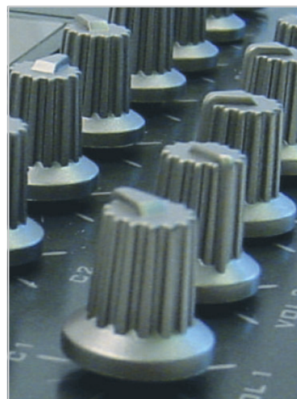
Cursorul în relief și rizurile permit manipularea ușoară a butoanelor.
