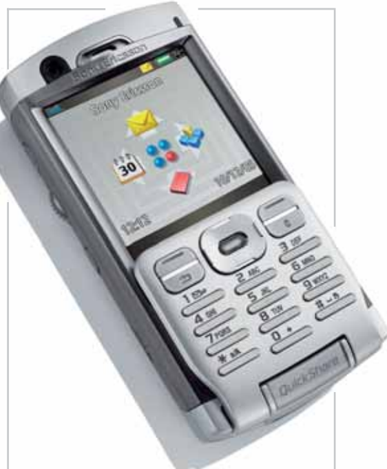
Tastele numerice se află la P990 pe o clapetă. Sub aceasta însă va putea fi întâlnită o tastatură QWERTY.
