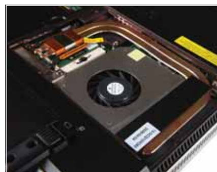
Sistemul de răcire al procesoarelor mobile este mic, dar foarte eficient.
