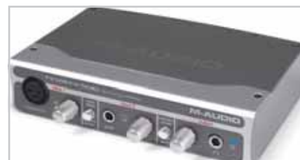
Firewire Solo – intrările de microfon și instrument sunt amplasate convenabil, frontal.
