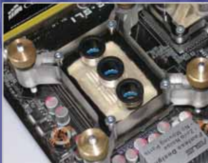
Blocul CPU din kit-ul complet are lamele și trei duze pentru circulația apei. Aerul iese din incintă prin duzele laterale.
