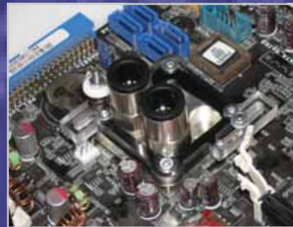
Blocul de răcire destinat chipset-urilor dispune numai de două duze pentru circulația apei.
