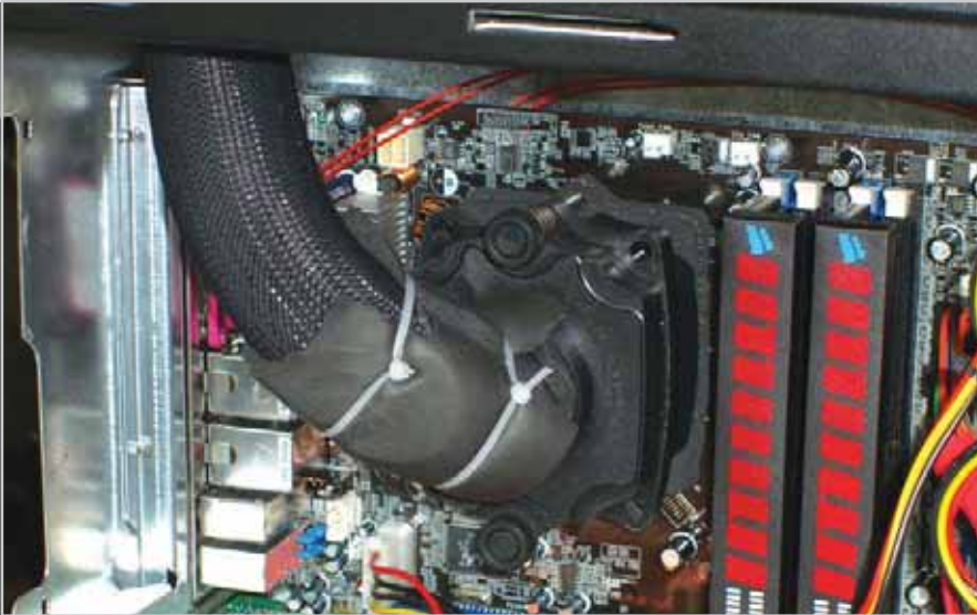
Din nou vaporizatorul, montat pe placa de bază. Observați cele două conducte care vin și pleacă din vaporizator și care sunt izolate termic extrem de atent.
